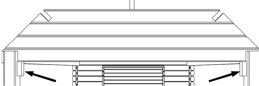
**NL:** Monteer, met 2x2 vijzen van 70 mm, op elke paal S onder de puntgevel CK/C7/3550/QQ002 het stukje u uit de zak met beslag met de breedste kant tegen de paal S (zie tekening).
