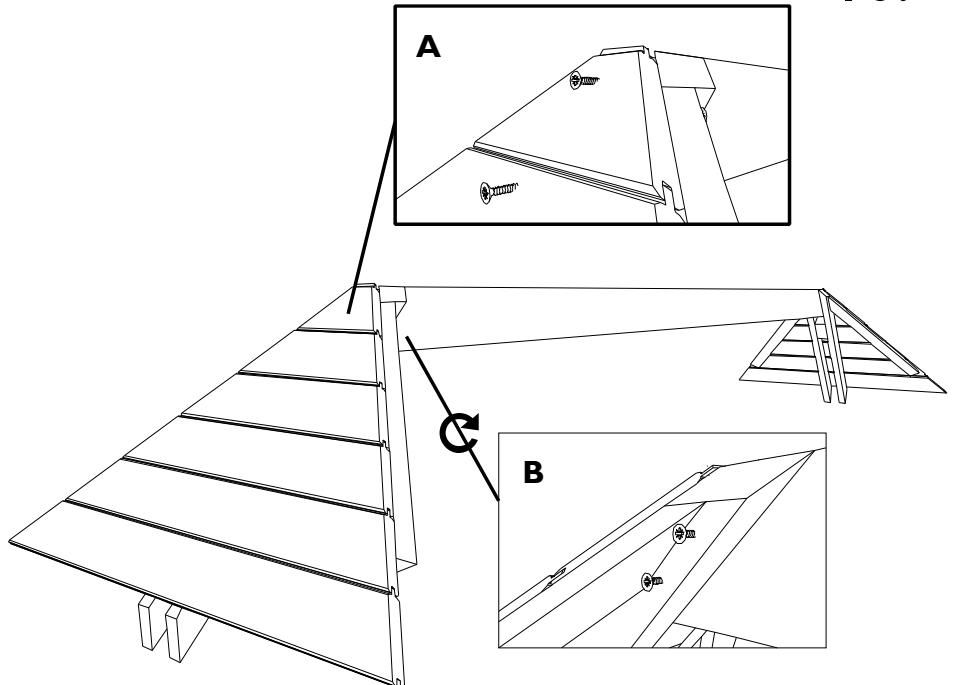
**NL:** Monteer, op grondniveau, aan beide kanten van de nokbalk 599908 een driehoek van het wolfsdak WD/C. Vijs 2 vijzen van 50 mm door de planchetten in de kop van de balk (detail A) en met 2x2 vijzen van 70 mm in de zijkanten (detail B).
