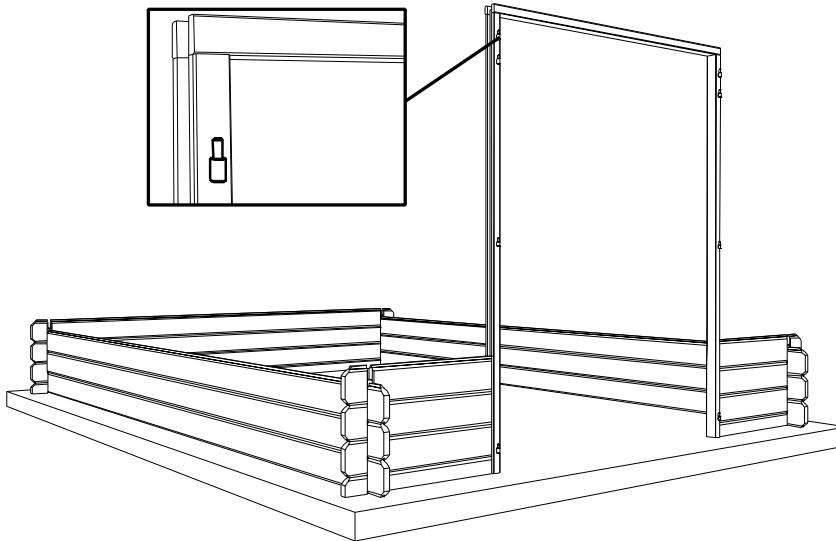
**NL:** Bouw verder op tot u ter hoogte van de onderkant van het raam komt. **Volg de plannetjes van de wanden uit het pakket van de extensie, voor de modellen met extensie.** Plaats 2 delen C1 langs elke kant waar het raam moet komen. U kan zelf kiezen of u het raam in de linker- of rechterwand plaatst. Laat het raam in de opening zakken.
