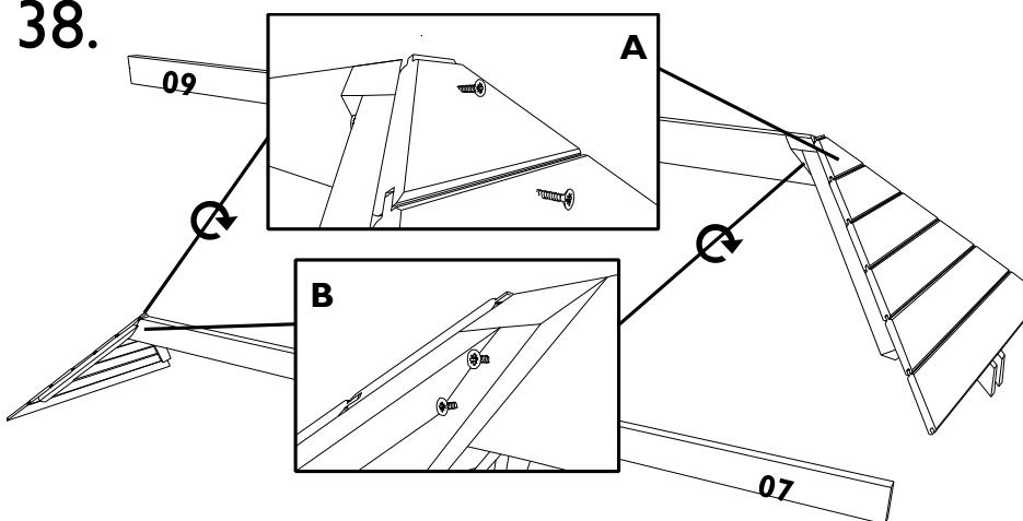
**NL:** Monteer, op grondniveau, op de schuine kant van de 2 nokbalken 599909 en 599907 een driehoek van het wolfsdak. Vijs 2 vijzen van 50 mm door de planchetten in de kop van de balk (detail A) en met 2x2 vijzen van 70 mm in de zijkanten (detail B). De nokbalk uit het basis pakket N zal niet gebruikt worden.
