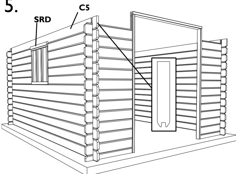
**NL:** Bouw verder, zoals aangegeven staat op de tekeningen van de wanden in de onderdelenlijst, tot u alle onderdelen C3 en C1 opgebruikt hebt. **Volg de plannetjes van de wanden uit het pakket van de extensie, voor de modellen met extensie.** Gebruik de planken uit het pakket van de extensie om het geheel 2 planken op te hogen.
