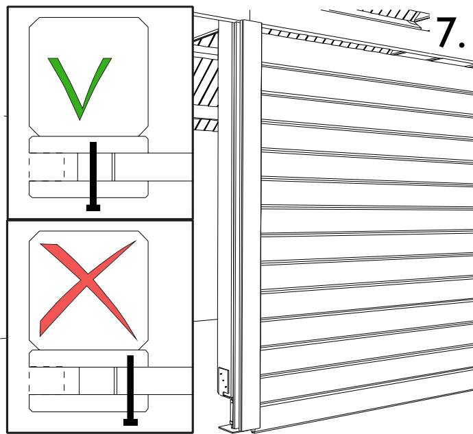
**NL:** Bevestig op de hoekpaal, met de bovenkant tegen de ligger, de lat FSL met 5 vijzen van 35 mm. Bevestig nu de lat S/028 met 5 vijzen van 50 mm aan de buitenrand van de lat FSL (zie detail).
