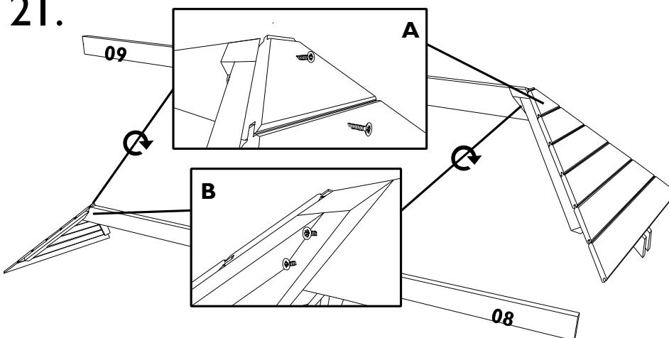
**NL:** Monteer, op grondniveau, op de schuine kant van de 2 nokbalken 599909 en 599907 een driehoek van het wolfsdak. Vijs 2 vijzen van 50 mm door de plancetten in de kop van de balk (detail A) en met 2x2 vijzen van 70 mm in de zijkanten (detail B). De nokbalk uit het basis pakket N zal niet gebruikt worden.
