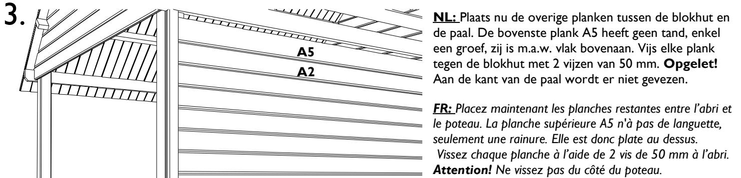
**NL:** Plaats nu de overige planken tussen de blokhut en de paal. De bovenste plank A5 heeft geen tand, enkel een groef, zij is m.a.w. vlak bovenaan. Vijs elke plank tegen de blokhut met 2 vijzen van 50 mm. **Opgelet!** Aan de kant van de paal wordt er niet gevoren.
