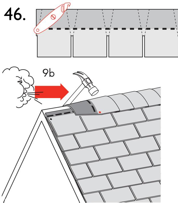
**NL:** Voor het afdekken van de nok dient U de shingles schuin in stukken zoals op de tekening op de pakken. Vervolgens legt U deze stukken overlappend op elkaar. Hou rekening met de richting van de stormwind bij de bepaling in welke richting U zal overlappen. Vernaagel met 2 nagels op de plaats die door het volgende stuk wordt overlaapt.
