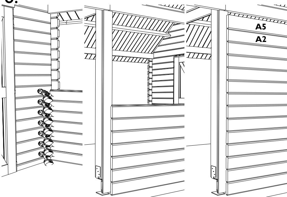
**NL:** Plaats de eerste 7 planken A2 tussen de blokhut en de paal zoals op de tekening. Vijs elke plank tegen de blokhut met 2 vijzen van 50 mm. **Opgelet!** Aan de kant van de paal wordt er niet gevezen. Plaats dan de overige planken tussen de blokhut en de paal. De bovenste plank A5 heeft geen tand, enkel een groef, zij is m.a.w. vlak bovenaan.
