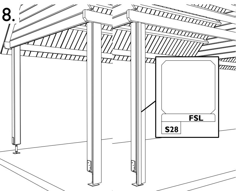
**NL:** Plaats nu de planken A2 en bovenste plank A5 in het midden tussen de latten FSL (detail A) en aan de voorkant tegen de paal (detail B). **Oogelet!** Aan geen enkele kant worden de planken gevezen.
