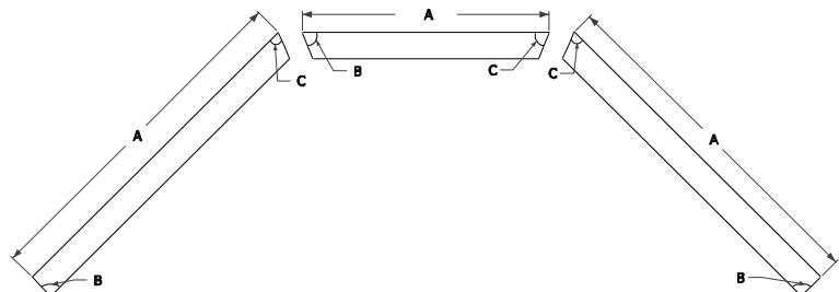
**NL:** Het dak dient nog afgewerkt met sierlatten voor- en achteraan. Zaag de meegeleverde FSL latten op lengte en met de hoek zoals opgegeven in de onderdelenlijst. Plaats eerst de FSL lat met de 2 schuine kanten net onder de shingles op het wolfsdakje, vernaagel aan de dakbalken. Vervolgens positioneert u 2 FSL met 1 schuine kant, vernaagel ook aan de dakbalken, aan lat C5 en aan de ZSL. Kit de spleet tussen de shingles en deze FSL latten af met siliconen (niet meegeleverd).
