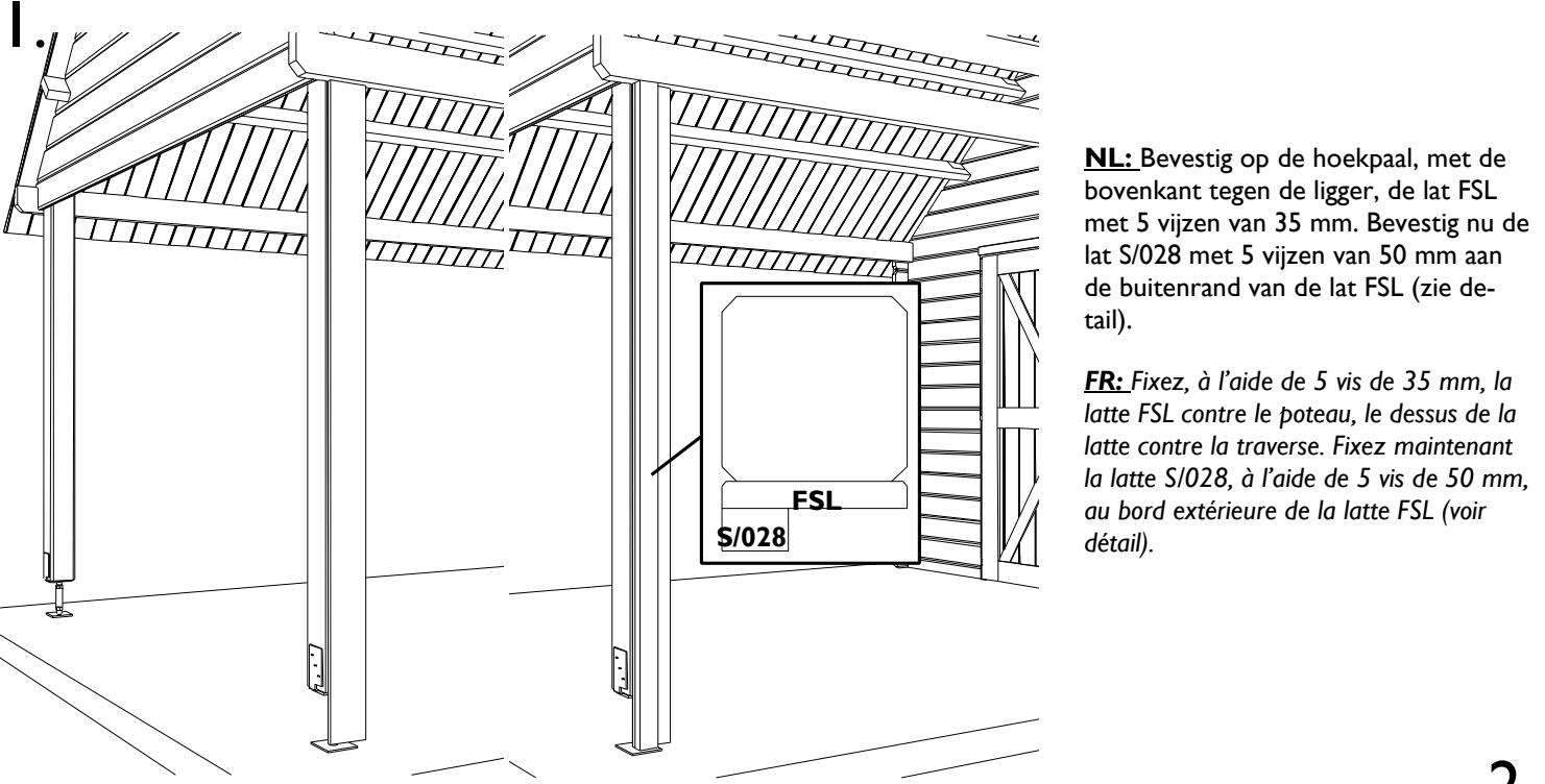
**NL:** Bevestig op de hoekpaal, met de bovenkant tegen de ligger, de lat FSL met 5 vijzen van 35 mm. Bevestig nu de lat S/028 met 5 vijzen van 50 mm aan de buitenrand van de lat FSL (zie detail).
