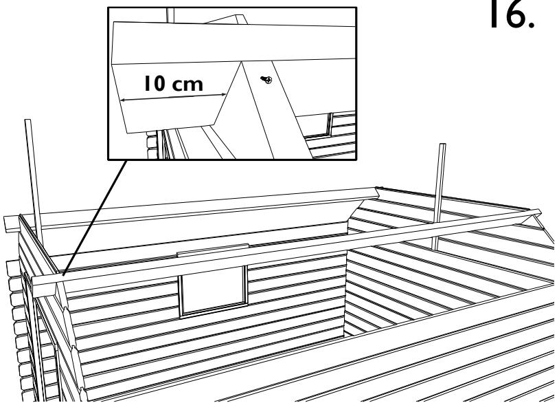
**NL:** Plaats de dakbalken P4/3550 in de uitsparingen van de puntgevels van de tuinberging. De dakbalk steekt 10 cm langs voor en achter uit de puntgevel. Vijs elke balk aan de puntgevel vast met een vijs van 70 mm (zie detail).
