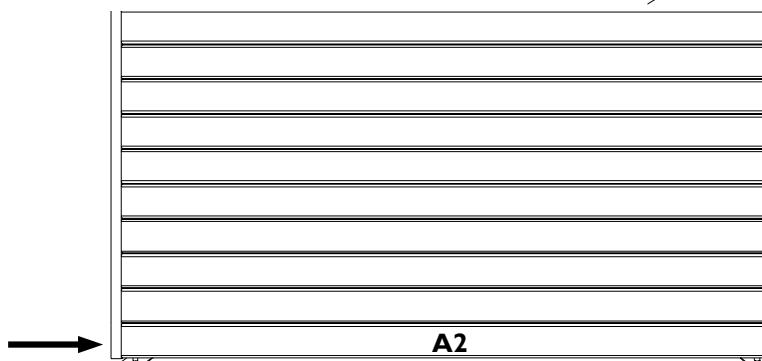
**NL:** Bevestig de onderste plank A2, door 2x2 vijzen van 70 mm door de latten S/028 te vissen.
