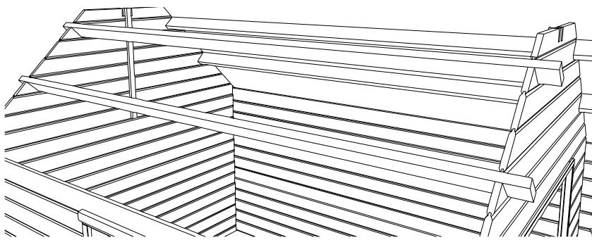
**NL:** (Niet voor modellen met maar 2 dakbalken) Plaats 2 dakbalken P4/3550 in de uitsparingen van de puntgevels. De dakbalk steekt 10 cm langs voor en achter uit de puntgevel. Vijs elke balk door de puntgevel vast met een vijs van 70 mm. (Herhaal stappen 8 en 9 voor modellen met meer dan 4 dakbalken).
