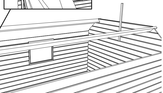
**NL:** Werk verder de puntgevels af. Zorg ook hier voor mooi oplopende kanten. Vijs met 2 vijzen, van 50 mm, per element, tegen de verstevigingslat S/028/045, herpositioneer deze lat eventueel zodanig dat deze tussen de 2 uitsparingen van het bovenste element van de puntgevel komt. Aan de voorkant dient u de verstevigingslat nog af te zagen gelijk met de bovenkant van de puntgevel (zie detail).
