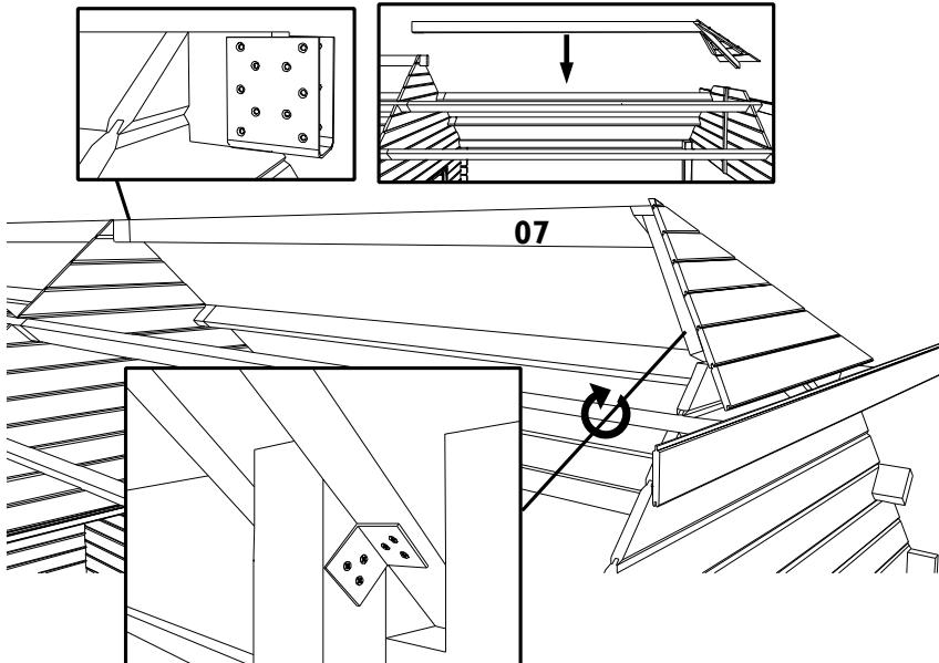
**NL:** Monteer een balkverlenger op de nokbalk van de tuinberging. Plaats aan de voorkant van de bovenste dakbalken een voorlopig hulpstuk (bv. een dakplanchet) als uitlijning. Plaats het gemonteerde geheel 599907 uit punt 21, in de balkverlenger en in de uitsparingen aan de bovenzijde van de voorste puntgevel en mooi aan-sluitend tegen het hulpstuk. Bevestig aan elke kant van de verstevigingslat S/028/045 een hoekijzer met vijzen van 25 mm. Het voorlopig hulpstuk mag nu weg ge-haald worden.
