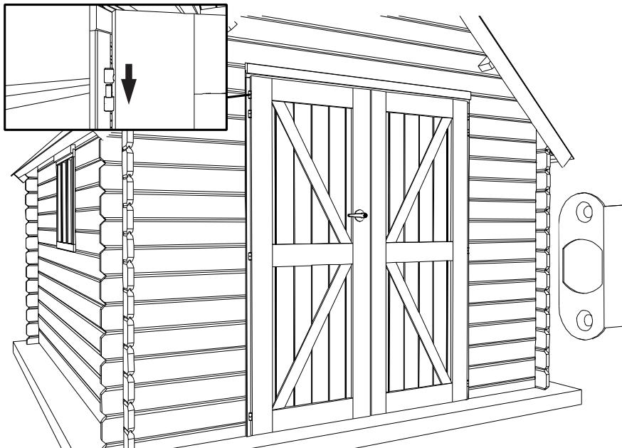
**NL:** Tot slot dient U enkel nog de afdekplatten boven raam en deur te plaatsen. Plaats binnen én buiten de sierlat SRD bovenop de kader van de deur. Zij dient om de opening bovenaan te verbergen tijdens het werken van het hout (cfr "hout leeft"). Zet vast met vijzen van 25 mm **op de kader**.
