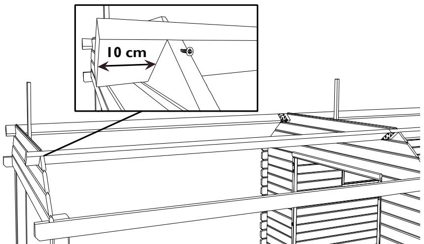
**NL:** Plaats de dakbalken P4/2950 van de extensie in de metalen balkverlengers en in de uitsparingen van de voorste puntgevel. De dakbalk steekt 10 cm langs voor uit de puntgevel. Vijs elke balk aan de voorste puntgevel vast met een vijs van 70 mm (zie detail tekeningen).
