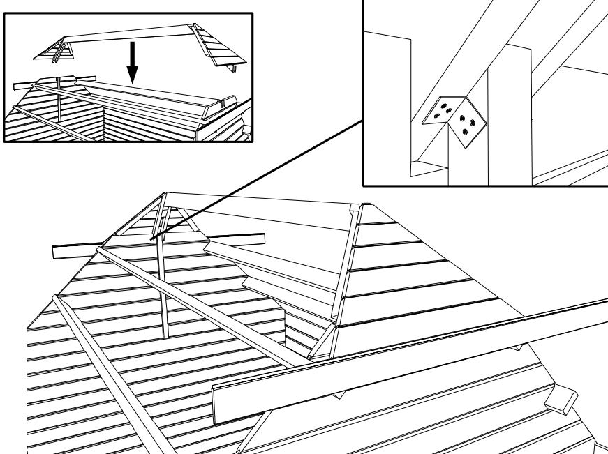
**NL:** Plaats aan voor- en achterkant van de bovenste dakbalken een voorlopig hulpstuk (bv. een dakplanchet). Plaats het gemonteerde geheel uit het bovenstaande punt, in de uitsparingen aan de bovenzijde van de puntgevels en mooi aansluitend tegen de hulpstukken. Bevestig aan elke kant van de verstevigingslat S/028/045 een hoekijzer met vijzen van 25 mm. Het hulpstuk mag nu weg gehaald worden.
