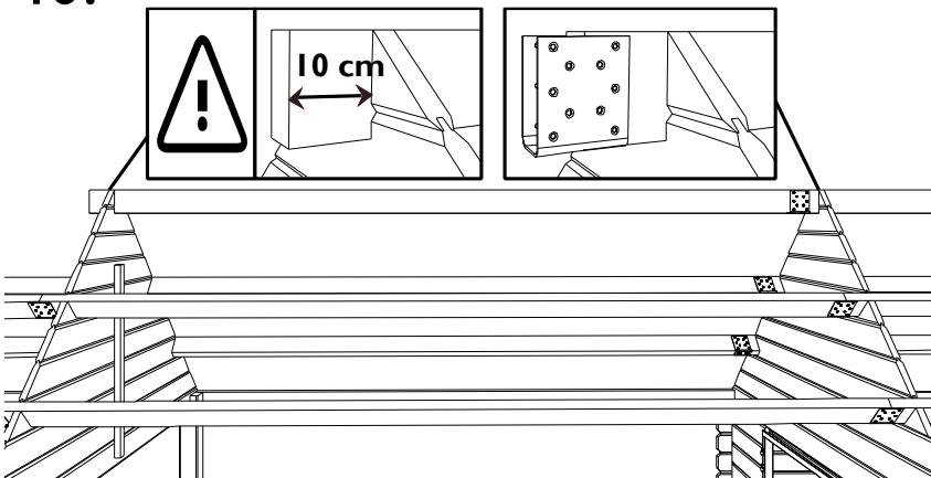
**NL:** Monteer een balkverlenger op de nokbalk van tuinberging. Plaats de nokbalk P4/2900 uit het uitbreidingspak XXL in de beugel en in de uitsparing van de puntgevel. De nokbalk streekt 10 cm langs voor uit puntgevel. Vijs de nokbalk aan de middelste puntgevel vast met een vijs van 70 mm.
