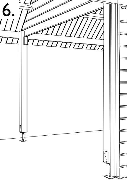
**NL:** Bevestig op de paal, met de bovenkant tegen de ligger, de lat FSL met 5 vijzen van 50 mm. **Oogelet!** Vijs in de onderliggende lat S/028 en niet in de wanden.
